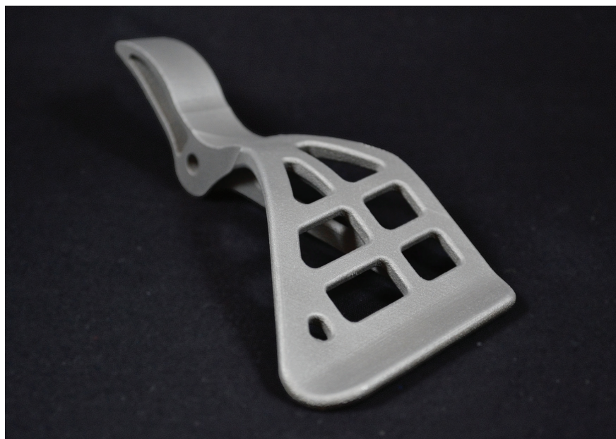
Ukázka vytištěného funkčního dílu pro automobilový průmysl. 3D výtisk z oceli na zařízení Concept Laser (foto: UPrint 3D)
